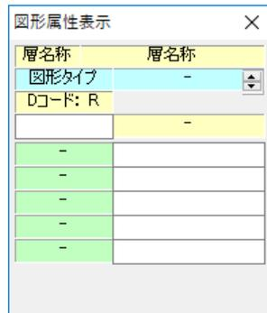
配線をクリックしますと下記画像のようにサブウィンドウに表示され、選択している配線はブリンク表示されます。
